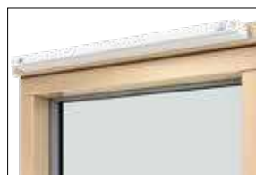
Ljudventil. Är inbyggd i en påförling som monteras på fönstrets överkarm. Utvändigt en alu-profil i samma färg som fönstret. Ljudventilen har en ljuddämpande effekt på Dn,e,w 40 dB. Se faktablad om ljudventilen på VELFAC.se
