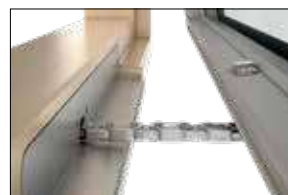
El-motor. El-motor är inbyggd i karmen och är inte synlig när fönstret är stängt. Levereras med tre olika kedjelängder med öppning 60mm, 210mm eller 440mm. Kan datorstyras och användas i hus med naturlig ventilation. Se min/max. på VELFAC.se
