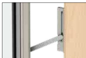
Låsbar öppningsspärr. Får inte användas på utrymnings- vägar. Finns inte till toppvänd- bart fönster och skjutdörrar.
